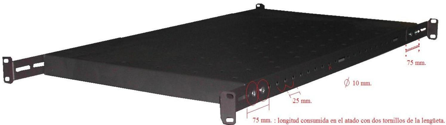
Atado de lengüetas, una a una, mediante conjunto de dos tornillos y tuercas M6. Regulación consecuente de lengüetas de 120 mm.: 45 mm. De 240: 165 mm. Paso de troqueles en lengüeta y bandejas de diámetro de 10 mm. Sucesión de agujeros en costados de bandejas cada 25 mm.
